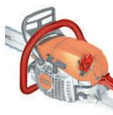
La empuñadura térmica eléctrica se encarga de mantener las manos secas y calientes y de mejorar el agarre, aumentando así la seguridad de manejo en invierno. Las láminas calefactoras exentas de mantenimiento y desgaste presentes en el tubo y en la empuñadura trasera se conectan según sea necesario, manteniendo los mangos calientes y secos.
